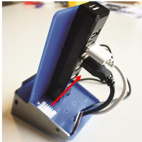
23. Befestige alle Kabel mit einem Kabelbinder am gMC 4.0 und zwicke diese auf die passende Größe ab.
