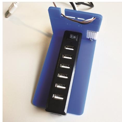
16. Stecke die Kabel des USB-Verteilers auf das Modul und ziehe diese durch die gleiche Ausnehmung wie das weiße Ladekabel.
