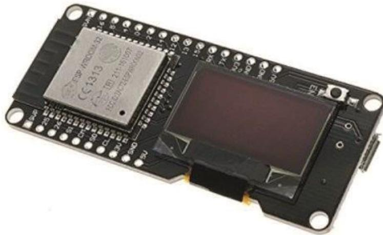
Der ESP32 ist ein ideales IoT-Device. Er hat zum leistungsstarken Controller ein Display (128 x 64 Pixel) sowie WLAN und Bluetooth.
